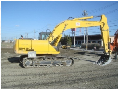
バックホウ ◆地盤改良用 スケルトンバケット装着
